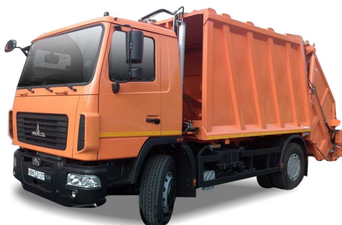
Фото 2.4 – Сміттєвоз МАЗ-5907С2-310 з об'ємом кузова 16 м 3
