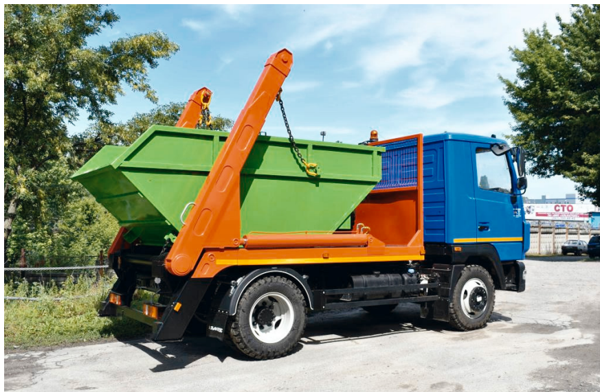
Фото 2.1 – Спецтранспорт обладнаний розвантажувально-завантажувальним механізмом
